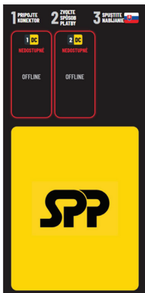
Nabíjací port je vypnutý softvérovo cez OCPP server. Ak nieje vypnutý cez OCPP server bude chyba v komunikácii s nabíjacím modulom
